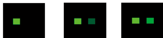
図-1 クロストークの例 (右眼用飛出し画像, 向かって右側がクロストーク) (左: クロストーク 0%, 中: クロストーク 10%, 右: クロストーク 30%)
